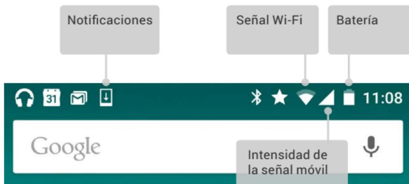
**SUGERENCIA:** La intensidad de la señal móvil y Wi-Fi se indica en la parte superior de la pantalla mediante barras de color blanco. Para ver si la red Wi-Fi seleccionada tiene conexión completa a Internet, abre Configuración rápida. Para ello, desliza dos dedos hacia abajo desde la parte superior de la pantalla.
